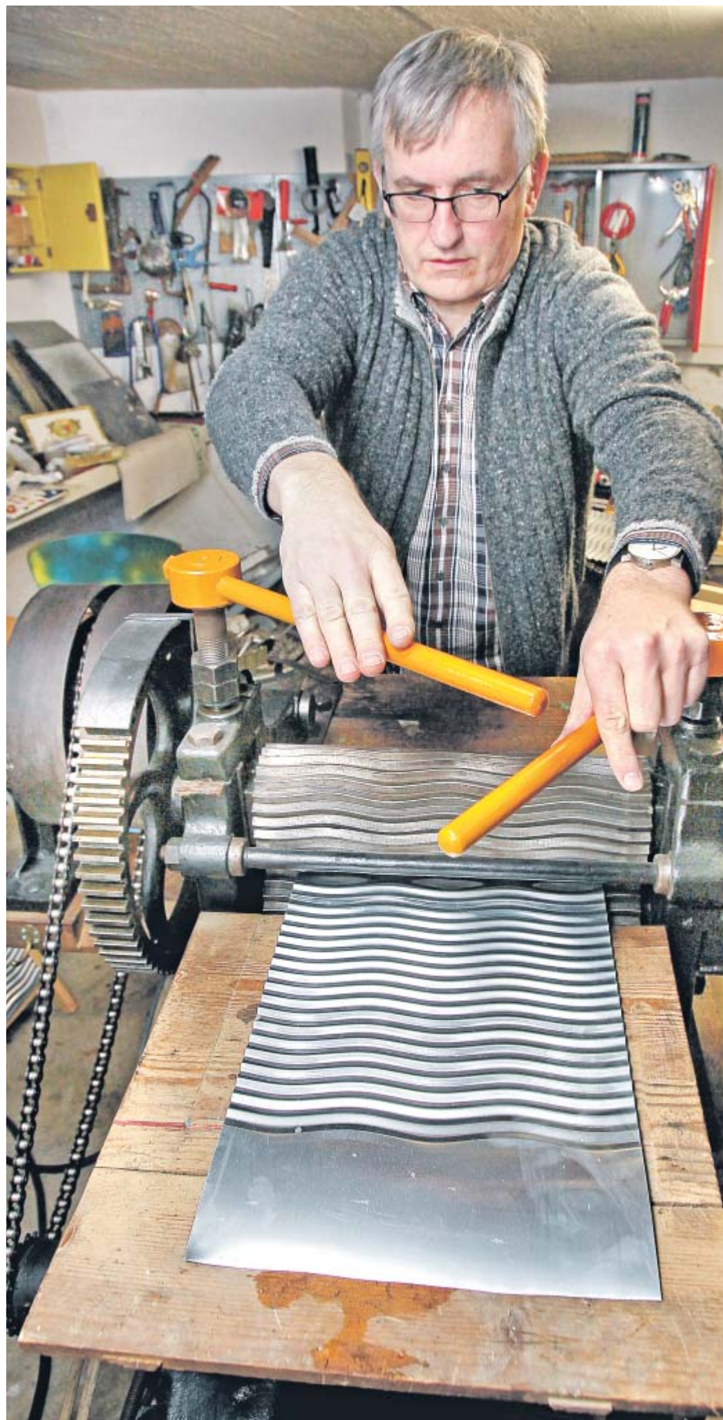
Riffelmaschine: Sie drückte in der Waschbretterfabrik von Peter Kießling in Weissenstadt (Bayern) die Riffel ins Blech – in zwanzig Jahren etwa eine Million mal. Wolfgang Voss hat sie in Bünde restauriert.
